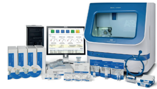
Іл. 90. Генетичний аналізатор (секвенатор) із комп'ютерним й програмним забезпеченням
